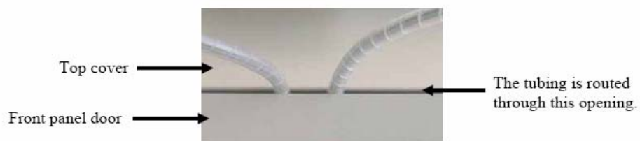
图 13: Ultimate 3000 泵预连接溶剂管路
